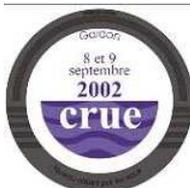
Le repère de crue est un disque blanc de 80 mm de diamètre minimum surchargé en partie basse d'un demi-disque violet (teinte 100%) avec trois vagues violettes (teinte 75%) dont l'horizontale indique le niveau des PHEC.
