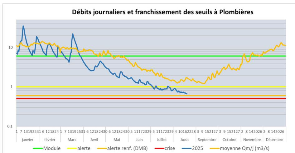
Au 20 août 2025, les débits journaliers observés restent inférieurs à la moyenne interannuelle. Sans surprise au vu des conditions météo, le débit a continué à baisser, approchant le seuil d'alerte renforcée à Plombières.
